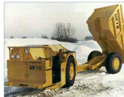
назначен для транспортировки горной массы по выработкам сечением не менее 2,85×2,3 кв. м. Вместимость кузова составляет 7 куб. м. Первый образец был изготовлен в июле 1979 г.
