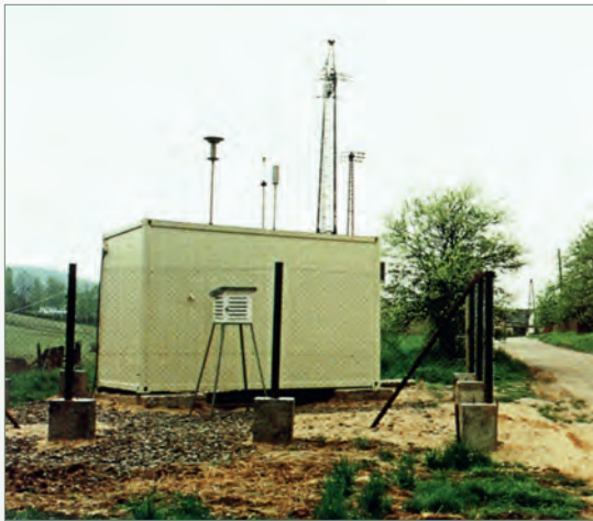
Автоматический измерительный контейнер для замеров Ra-226 и запыленности (фото из архива Wismut GmbH)
