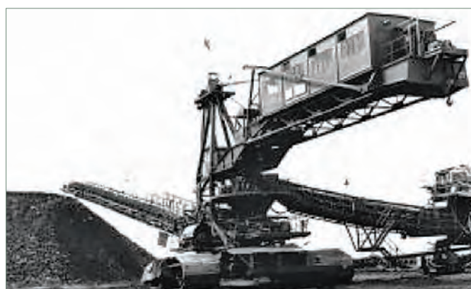
Отвальный мост на карьере Лихтенберг.
