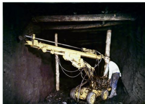
Самоходная буровая каретка БВК в блоке (фото из архива Wismut GmbH).
