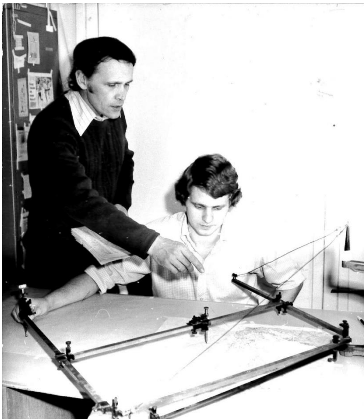
Perspektivabteilung: GL-Geologe Anatoli K. Sokolovski und Kollektor Udo Heinz am Pantografen zur Verkleinerung/ Vergrößerung geologischer Karten 1976 Archiv Udo Heinz
